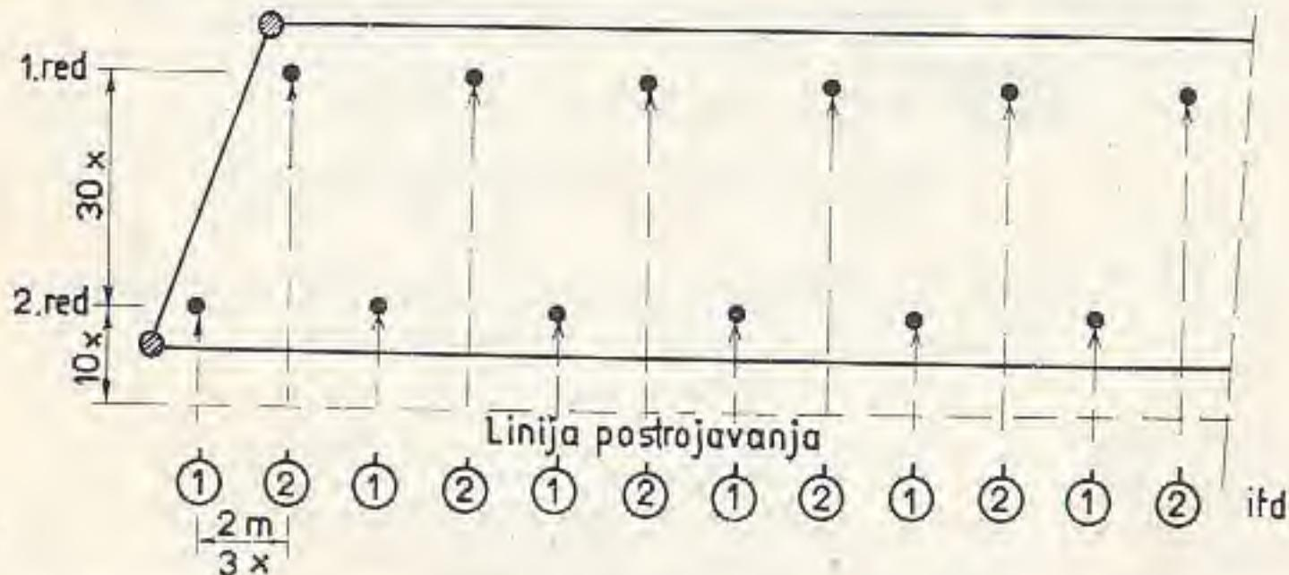
Sl. 18 — Način raspoređivanja protivtenkovskih mina strojnim rasporedom u minskom polju gustine 0,5 mina/metak — treći način
